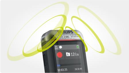
Voice Tracer dispone di due microfoni stereo integrati, progettati per effettuare registrazioni vocali nitide e ridurre i rumori di disturbo. Registrazioni di ottima qualità sono fondamentali per ottenere una riproduzione nitida e un riconoscimento vocale preciso.
