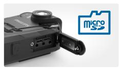
Capacité de stockage et d'enregistrement quasi illimité grâce à l'entrée pour carte mémoire micro SD prenant en charge jusqu'à 128 Go de mémoire.
