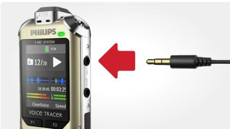
Schließen Sie den Recorder einfach mit dem mitgelieferten Line-in-Kabel an, und starten Sie die Aufnahme von einer externen Klangquelle.
