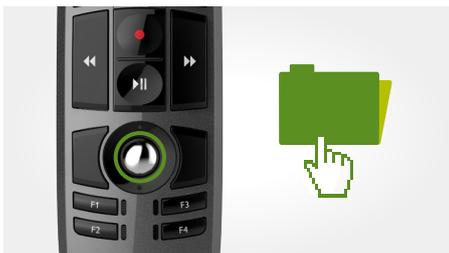
L'appareil est équipé d'un trackball, qui permet à l'utilisateur de contrôler et de naviguer facilement entre les applications pendant l'enregistrement, sans devoir alterner entre la souris et le microphone. Il est possible de retirer le trackball de l'appareil pour le nettoyer, en cas de besoin. Les paliers en téflon auto-lubrifiés et résistants à l'abrasion garantissent un bon fonctionnement sur toute la durée de vie de l'appareil.
