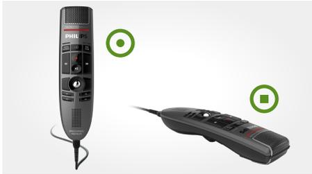
À la pointe de la technologie, le SpeechMike Premium est doté d'un détecteur de mouvement intégré, ce qui en fait le premier appareil de dictée statique contrôlé par le mouvement de la main. Il détecte lorsqu'il est posé sur une table, désactive le son du microphone et une fois qu'il est repris en main, rétablit le son du microphone. De plus, il permet de programmer des événements personnalisés, comme l'interruption et la reprise de l'enregistrement.
