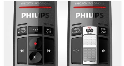
Le SpeechMike Premium est doté d'un interrupteur à curseur ou d'un bouton poussoir. L'interrupteur à curseur est résistant à l'usure et ergonomique avec une surface lisse et douce pour une sensation tactile douce et une utilisation confortable et intuitive. De plus, nos ingénieurs ont mis en œuvre une détection de curseur sans contact éprouvée, rendant l'appareil entièrement résistant à l'usure pour une très longue durée de vie.
