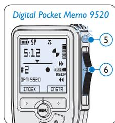
**9** Se il dettato non è ancora terminato, raggiungere la fine del file con il pulsante di avanzamento rapido e proseguire con la registrazione.
